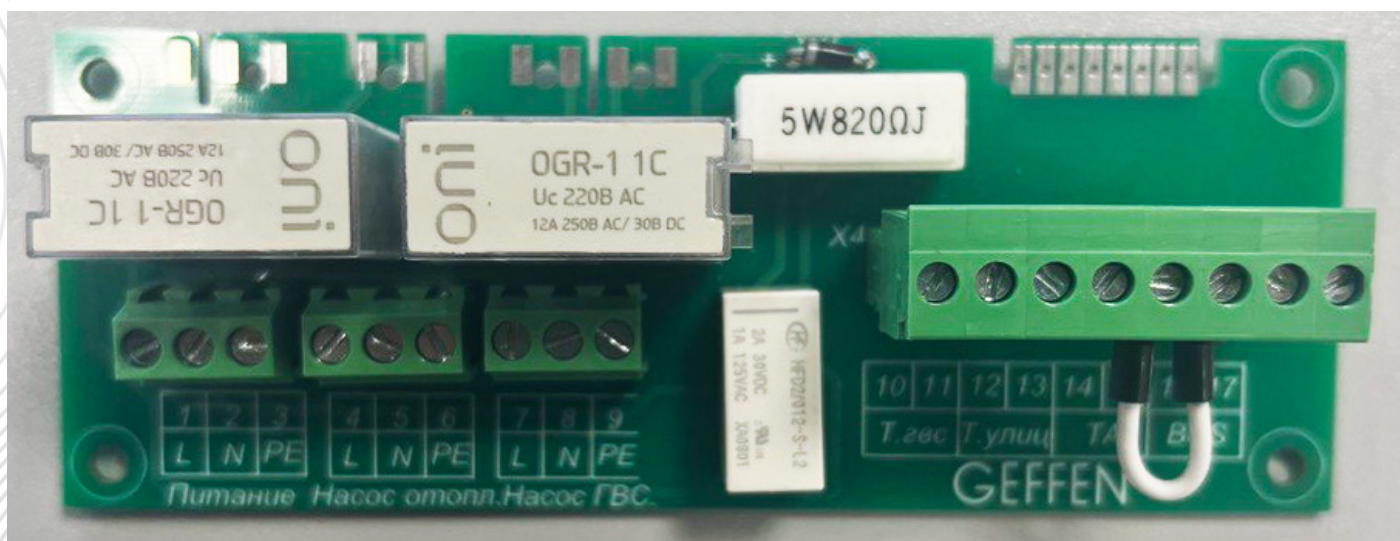
Рисунок 9 б. Плата ввода питания котла МВ 4.1 40-99 кВт
