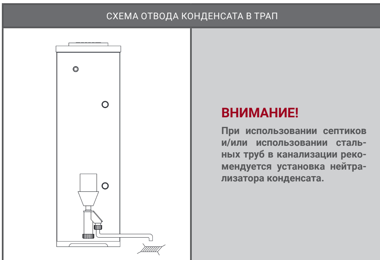
Рисунок 6 а. Схема отвода конденсата в трап
